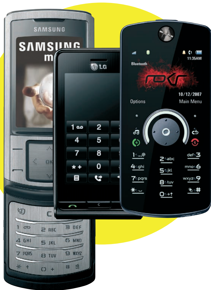
Samsung U900, LG KU990 и Motorola ROKR E8 (слева направо): эта подборка наглядно демонстрирует недостаток одновременного присутствия в модели большого дисплея и поддержки UMTS. У LG, в которой есть и то, и то, самое короткое время работы, Motorola же, наоборот, демонстрирует наибольшую «стойкость»
