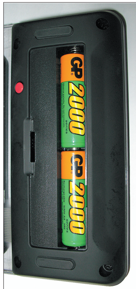
Рядом с батарейным отсеком – красная кнопка для синхронизации с USB-адаптером
